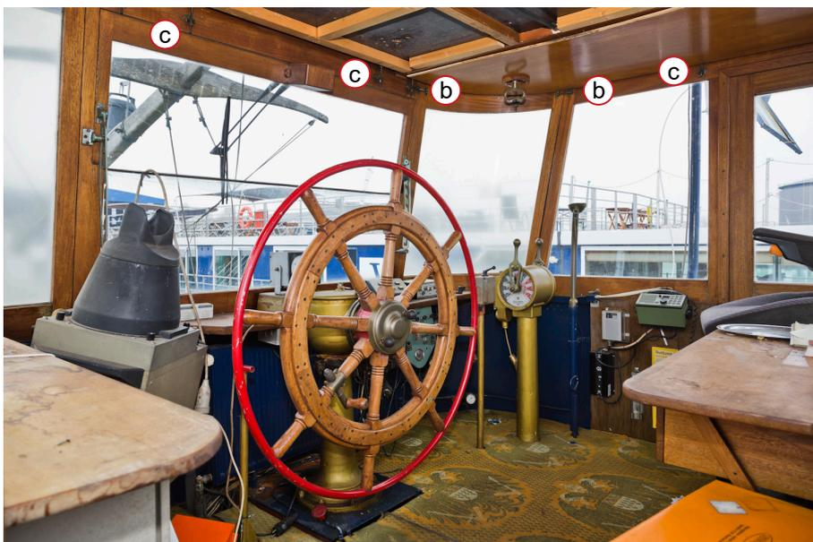
2 Innenansicht der Holzrahmenelemente im Ruderhaus. Unterhalb der Decke sind die Spannschrauben zur Verbindung der Holzrahmenelemente angeordnet.
