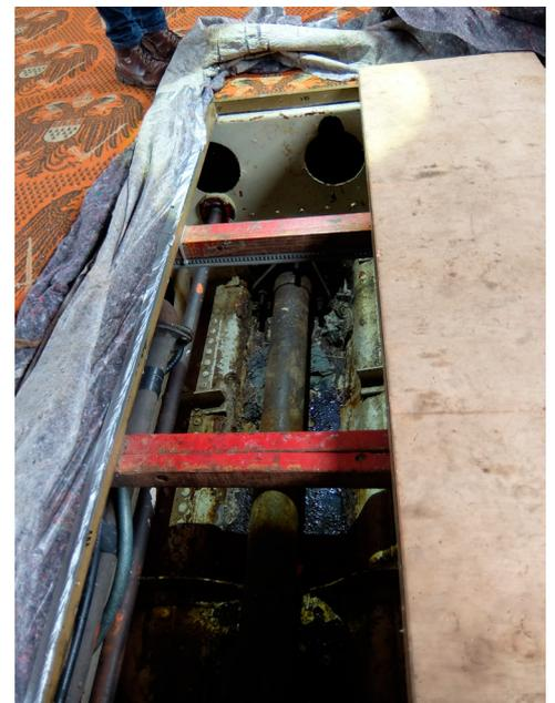
3 Kontrolluke Backbord mit Antriebswelle und Axiometerleitung
