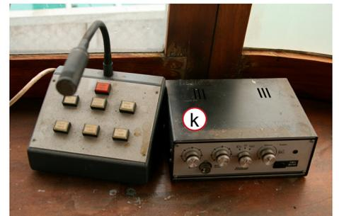
Bordsprechanlage mit Verstärker
