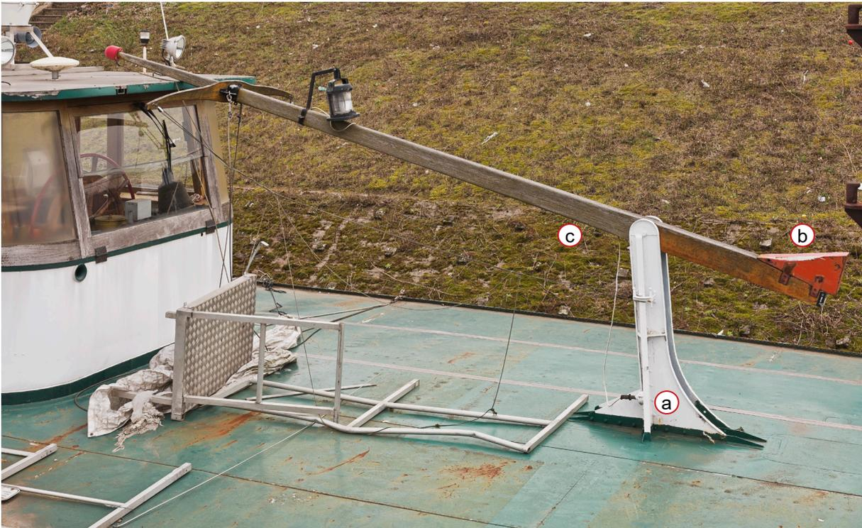
1 Kippmast Dachfläche, Vorderschiff
