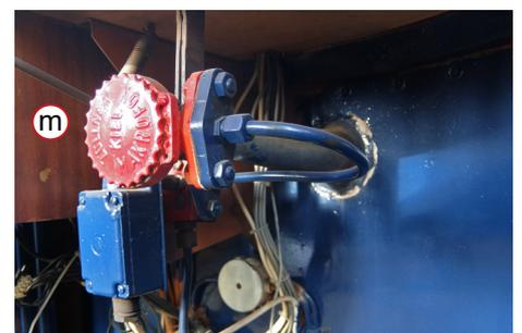
Typhon mit Bedienhebel und Schalltrichter
