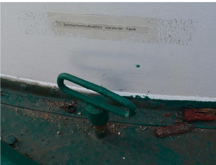
2 Absperrvorrichtung für die Benzinleitung zum Stromaggregat der Ankerwinde in der Vorpiek, ca. 1980er Jahre
